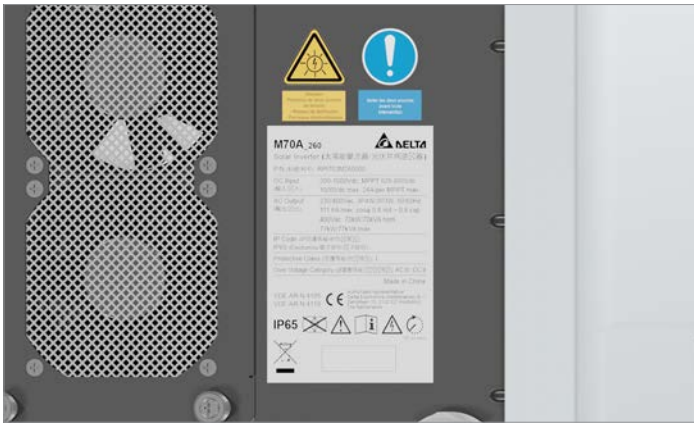
Fig. 4.27 : Plaque signalétique et marquages
