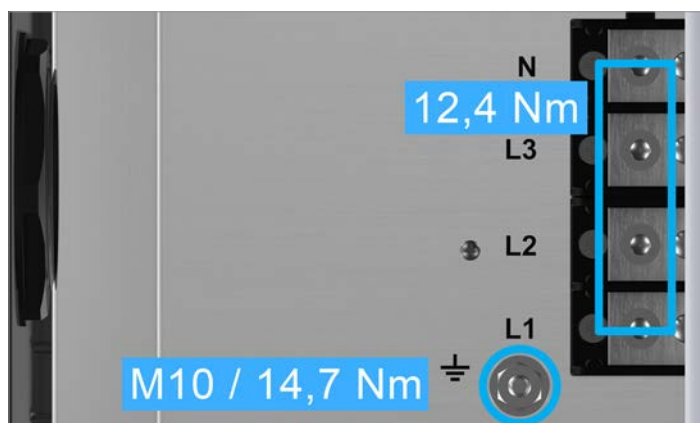
Fig. 7.9 : Couples de serrage pour bornier AC
